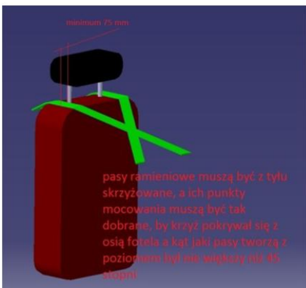
1001-4 Schemat zamocowania pasów szelkowych do fotela seryjnego
